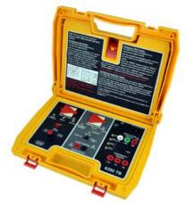
Устройство для проверки: тестеров УЗО, измерителей петли фаза-ноль, измерителей сопротивления изоляции 6280 ТВ STANDARD ELECTRIC WOKRS Co., Ltd.
