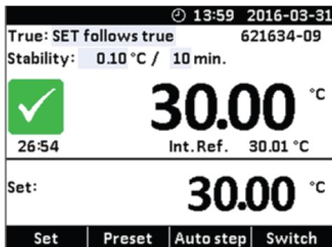
Все внешние эталонные термометры для калибраторов температуры СТС-R исполнения С являются интеллектуальными, то есть имеют в своем разъеме чип памяти, в котором размещены данные термометра: модель, серийный номер, температурный диапазон, индивидуальные калибровочные коэффициенты, дата калибровки и межпроверочный интервал.
