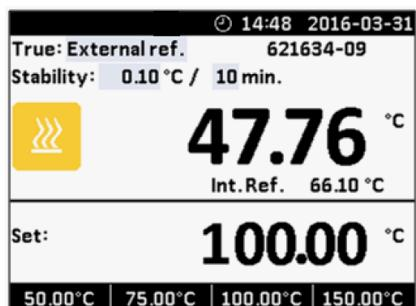
В режиме предустановок вы можете просто выбрать функциональной клавишей одно из предустановленных значений температуры.
