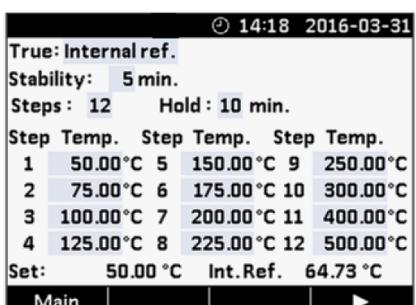
Тест очень удобен для проверки вторичной регистрирующей аппаратуры (потенциометры, мосты, АСУ ТП). Необходимо задать число шагов, значение температуры на каждом шаге, время стабилизации на шаге, общее время теста и запустить тест.
