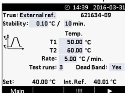
Простой и удобный тест реле температуры. Необходимо задать минимальную и максимальную температуру, скорость изменения температуры, число повторов и запустить тест. По окончании теста будут показаны усредненные значения температуры при срабатывании реле.
