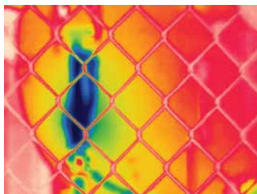
Пассивные системы автоматической фокусировки часто захватывают только ближайший предмет, в данном случае, это проволочное ограждение.
