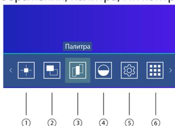
1. Измерение: настройка отображения измеряемых точек на экране тепловизора. Температура в центральной точке, самая высокая температура, самая низкая температура, температура в области.
