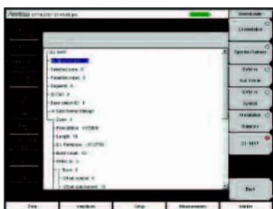
Экран DL MAP отображает информацию зоны DL MAP в формате дерева решений
