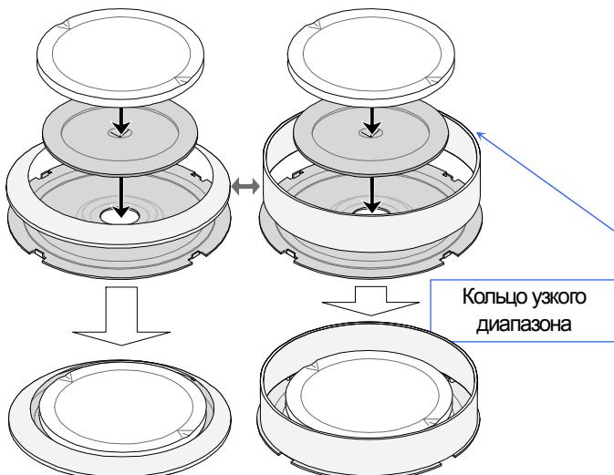
Используйте кольцо узкого диапазона, чтобы избежать ошибок, вызванных циркуляцией воздуха при взвешивании с минимальной индикацией в 0,01 мг.
