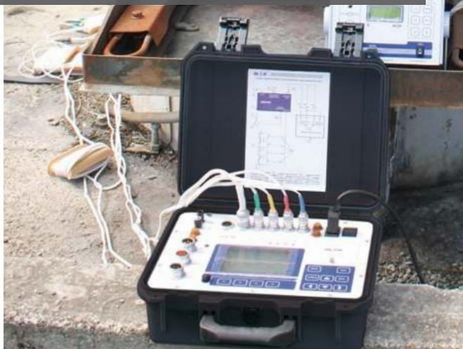
ДОПОЛНИТЕЛЬНОЕ ОБОРУДОВАНИЕ ДЛЯ ПРИБОРОВ КОНТРОЛЯ ВЫСОКОВОЛЬТНЫХ ВЫКЛЮЧАТЕЛЕЙ
