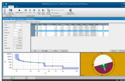
Программное обеспечение накладывает характеристики каждого из элементов на графике I/t и диаграмме направленности. В их число входят все элементы, которые реагируют на примененный тип неисправности. Для каждой точки испытания выполняется оценка работы реле по допускам на измерение тока и времени работы.
