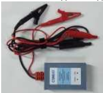
Блок питания датчиков поэлементного контроля № 1
