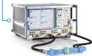
Измерение параметров материалов в волноводе
