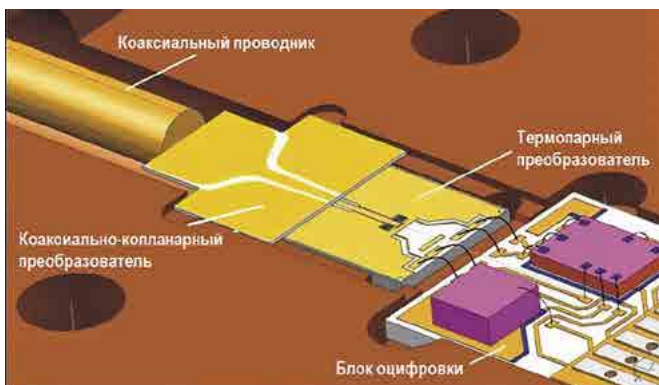
Входной каскад ВЧ-тракта с коаксиально-копланарным преобразователем
