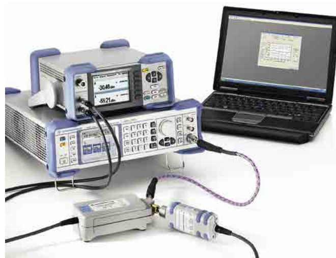
Измерительная установка для калибровки преобразователя мощности NRP-Z55
