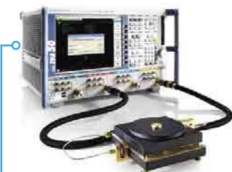
Измерение параметров пленок на основе резонатора
