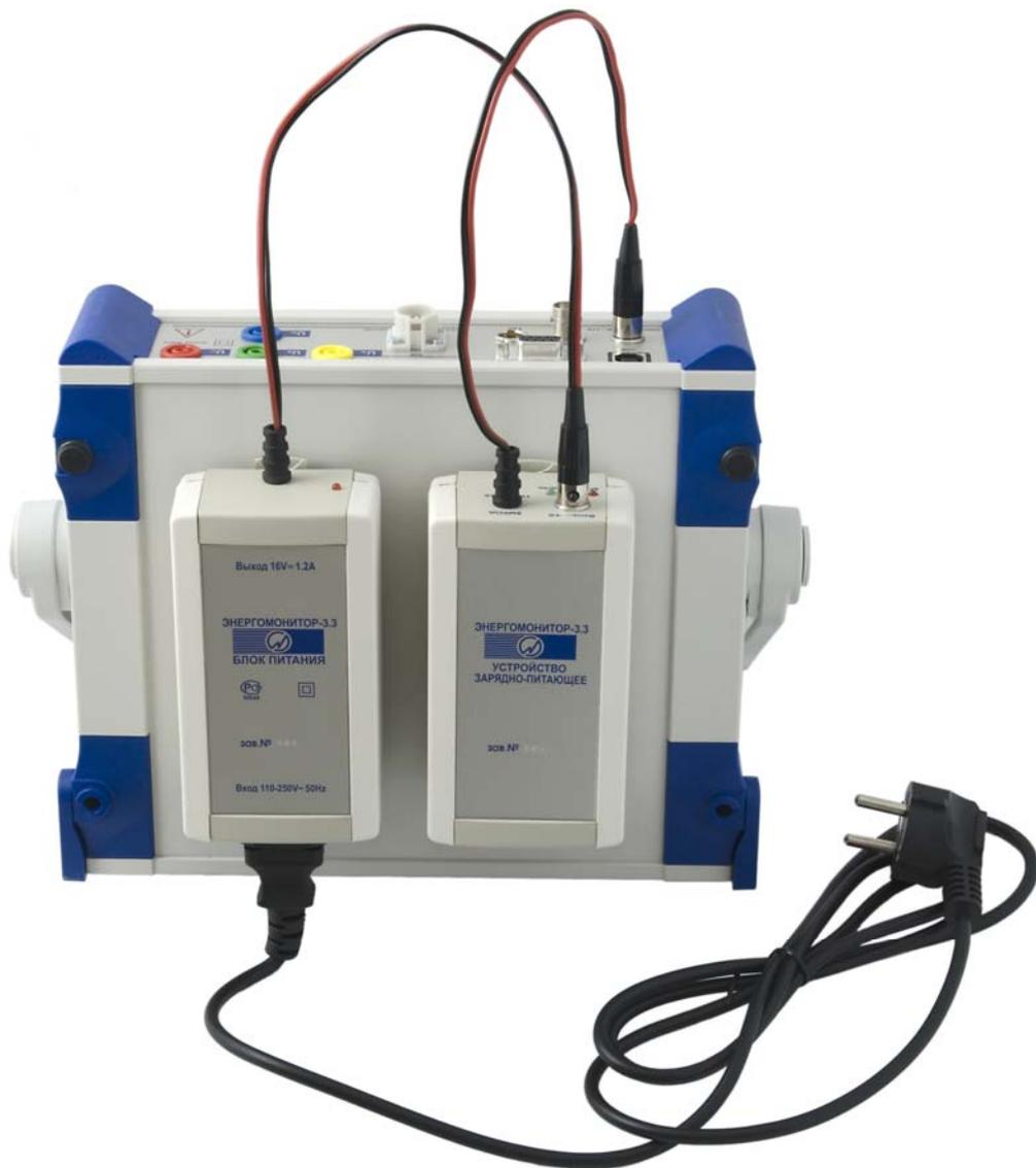
Рисунок В3 Схема включения Прибора ЭМ-3.3Т1 через устройство зарядно-питающее и сетевой адаптер.
