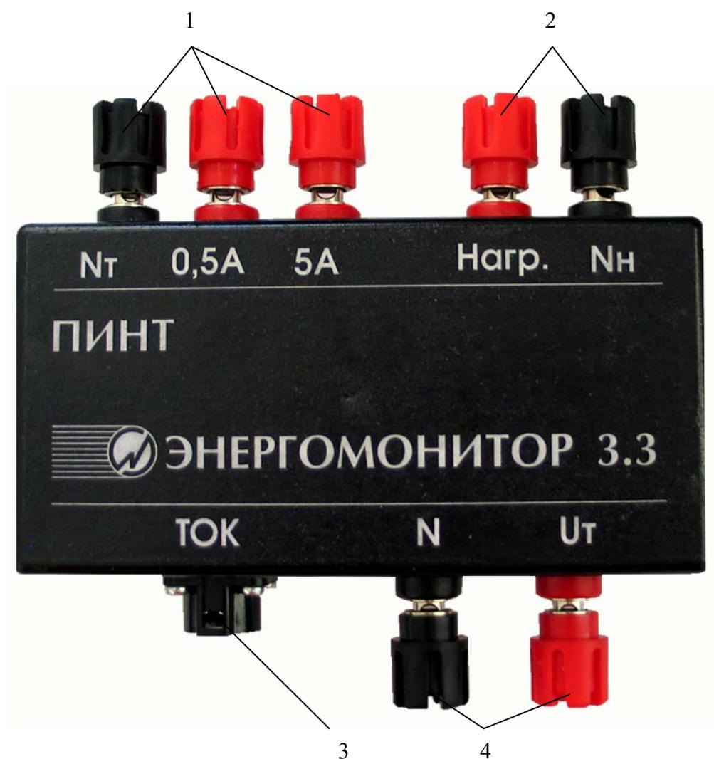
1 – клеммы подключения вторичной обмотки ИТ; 2 – клеммы подключения нагрузки; 3 – разъем подключения к токовым входам Прибора ЭМ-3.3Т1; 4 – клеммы подключения к входам напряжения Прибора ЭМ-3.3Т1.
