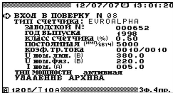
Рисунок 4.4.1 Окно входа в режим поверки счетчиков
