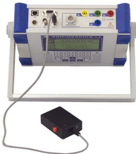
Рисунок В13 Схема подключения ПФИ к Прибору ЭМ-3.3Т1 при проверке индукционных и электронных (с оптическим импульсным выходом) счетчиков.
