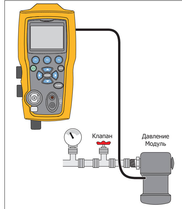
Рисунок 4. Измерение давления при помощи внешних модулей
