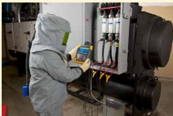
Просто подключите провода для измерения напряжения и гибкие токоизмерительные датчики к источнику электроснабжения двигателя.
