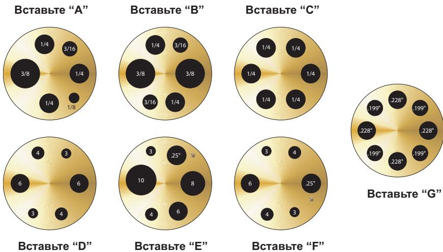
Рисунок 4 Варианты вкладышей Metrology Well. Размеры зондов указаны в дюймах для А, В и С и в миллиметрах для гильз D, Е и F, кроме 0,25-дюймовых эталонных отверстий в Е и F.
