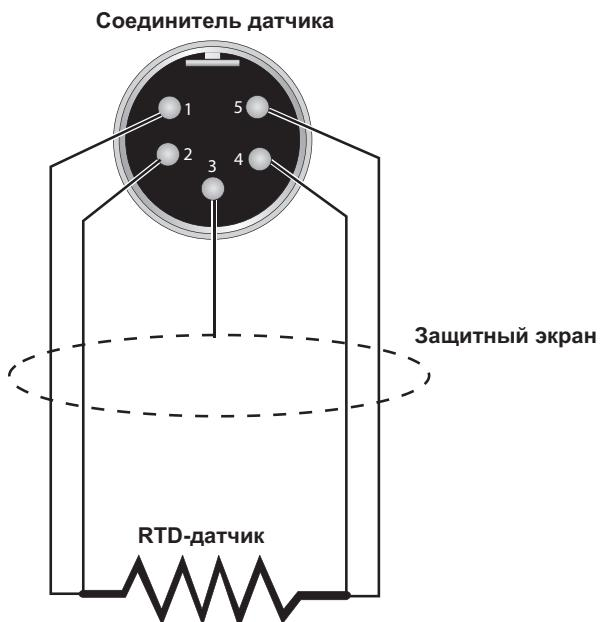
Рисунок 1 Подключение разъема зонда
