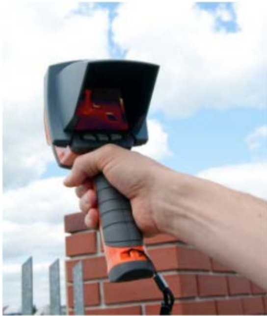
Рисунок 67. Применение солнцезащитного козырька
