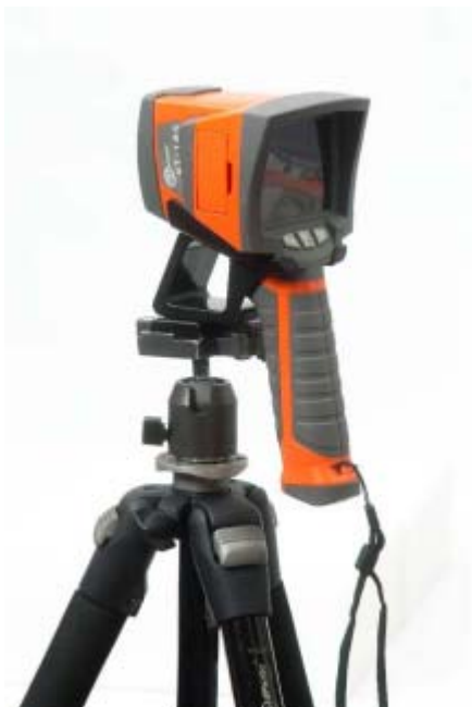
Рисунок 68. Применение кронштейна для установки на штатив
