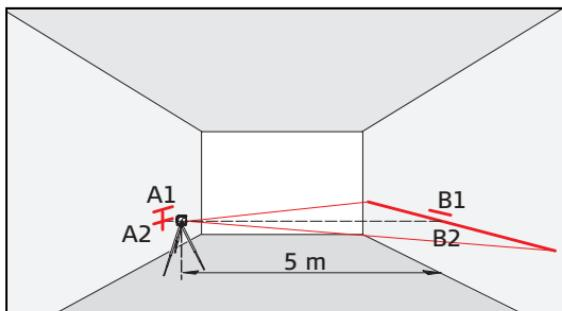
Затем поместите прибор на той же высоте как можно ближе к стене А и снова отметьте горизонтальную линию лазера или лазерную точку на стене А (-> A2). Разверните прибор на 180 градусов снова и сделайте отметку на стене В (-> B2). Измерьте расстояние между отмеченными точками A1-A2 и B1-B2. Подсчитайте разницу между двумя замерами. Если разница не более 2 мм, значит точность прибора Leica Lino в пределах допустимого.
