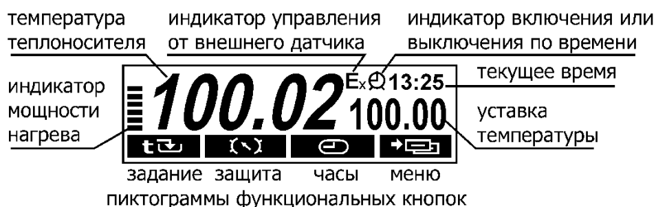
Рисунок 4 — Дисплей в режиме регулирования по уставке
