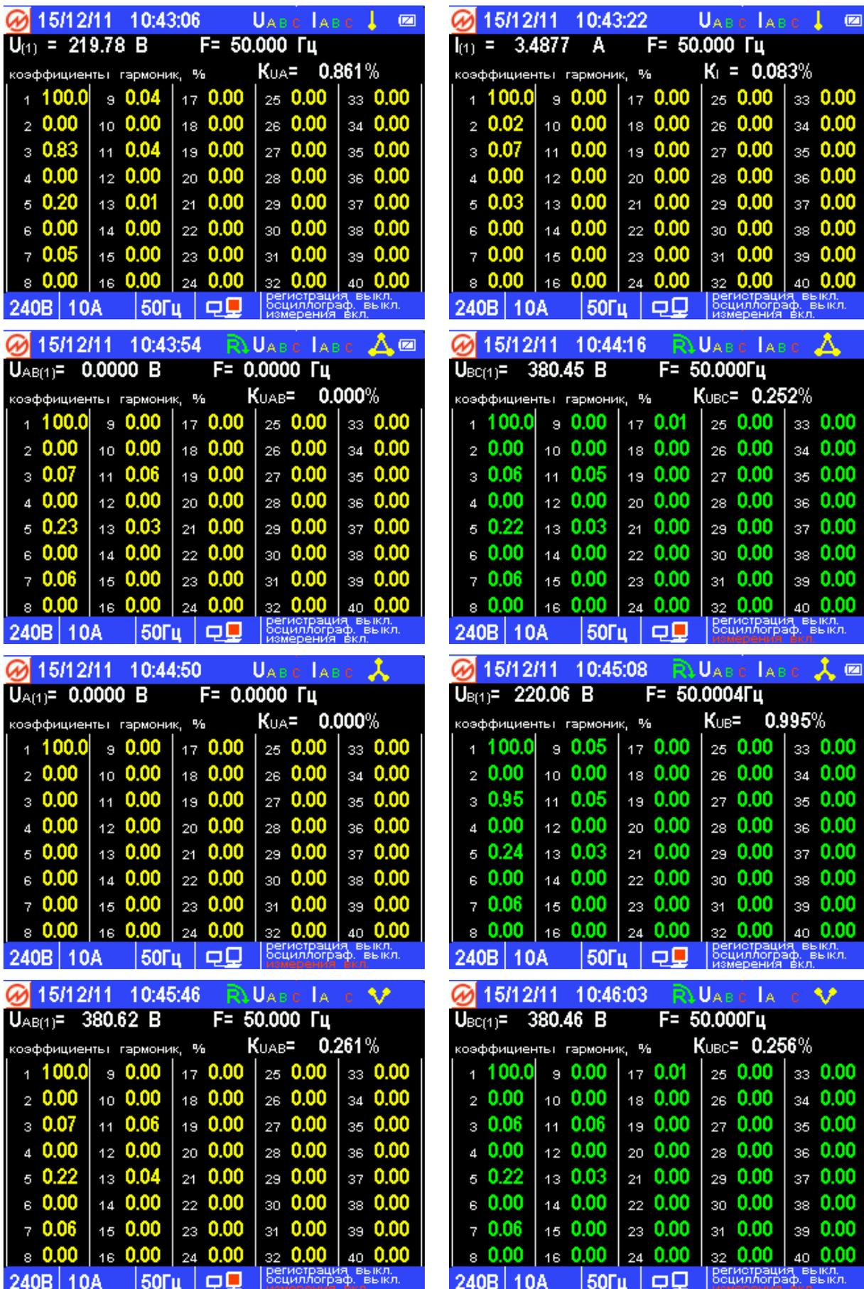
Рис. 4.11. Экраны режима отображения гармонических составляющих напряжения и тока для различных схем подключения
