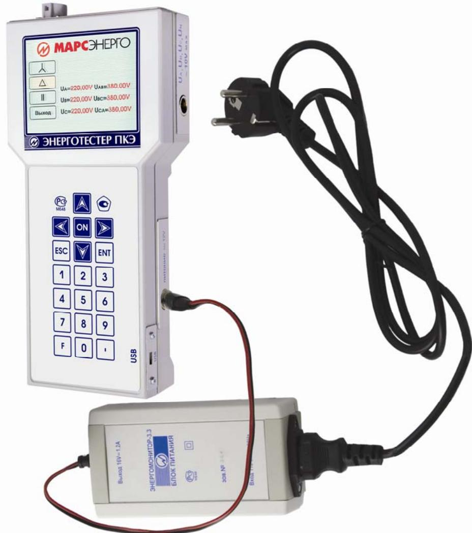
Рис. Б.1. Схема включения Энерготестера ПКЭ через сетевой адаптер
