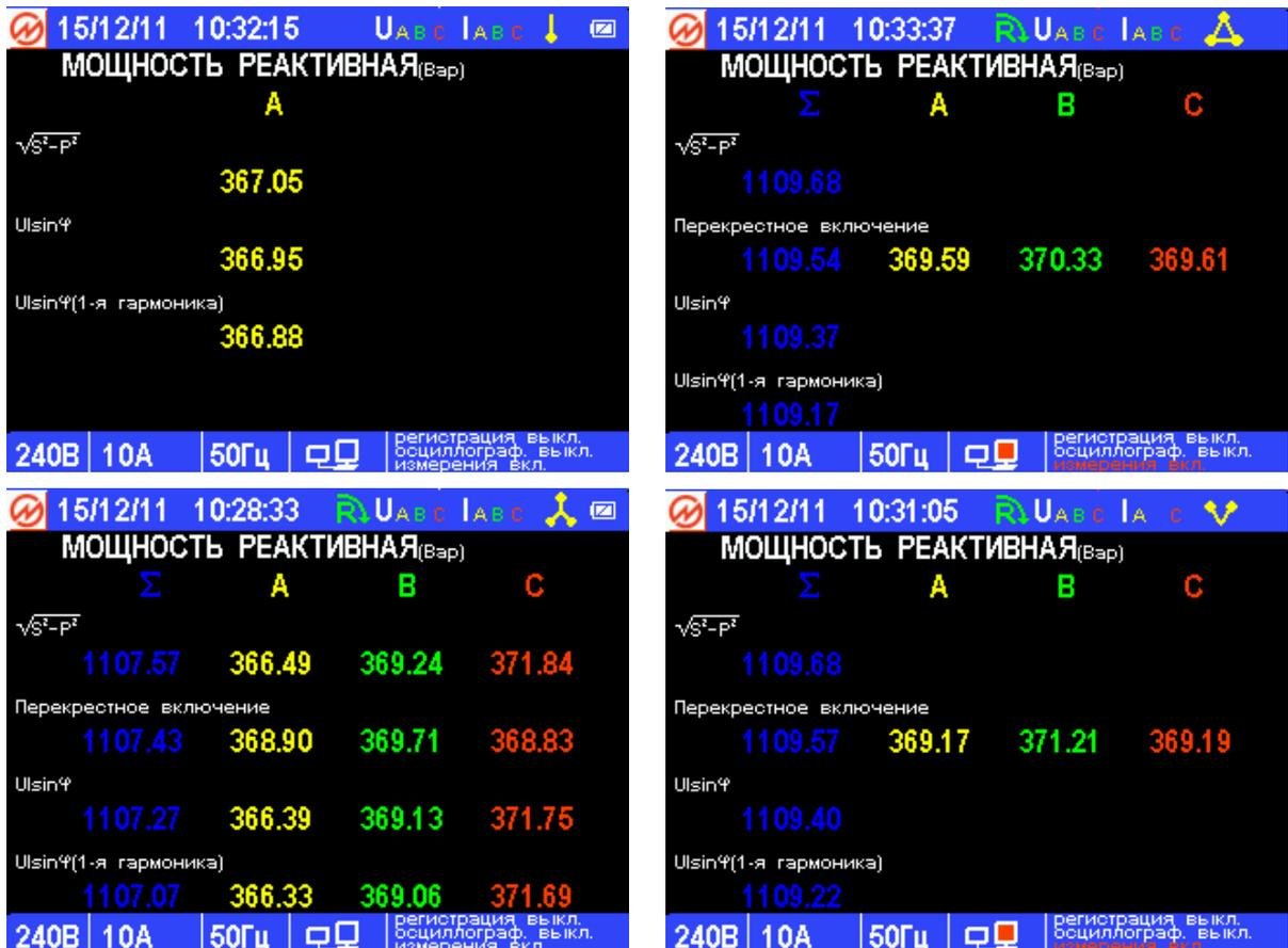
Рис. 4.8. Экраны режима отображения реактивной мощности для различных схем подключения
