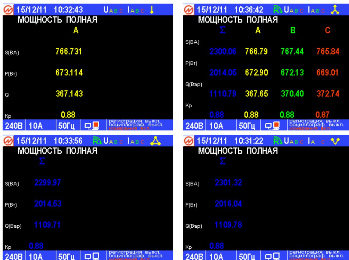
Рис. 4.9. Экраны режима отображения полной мощности для различных схем подключения
