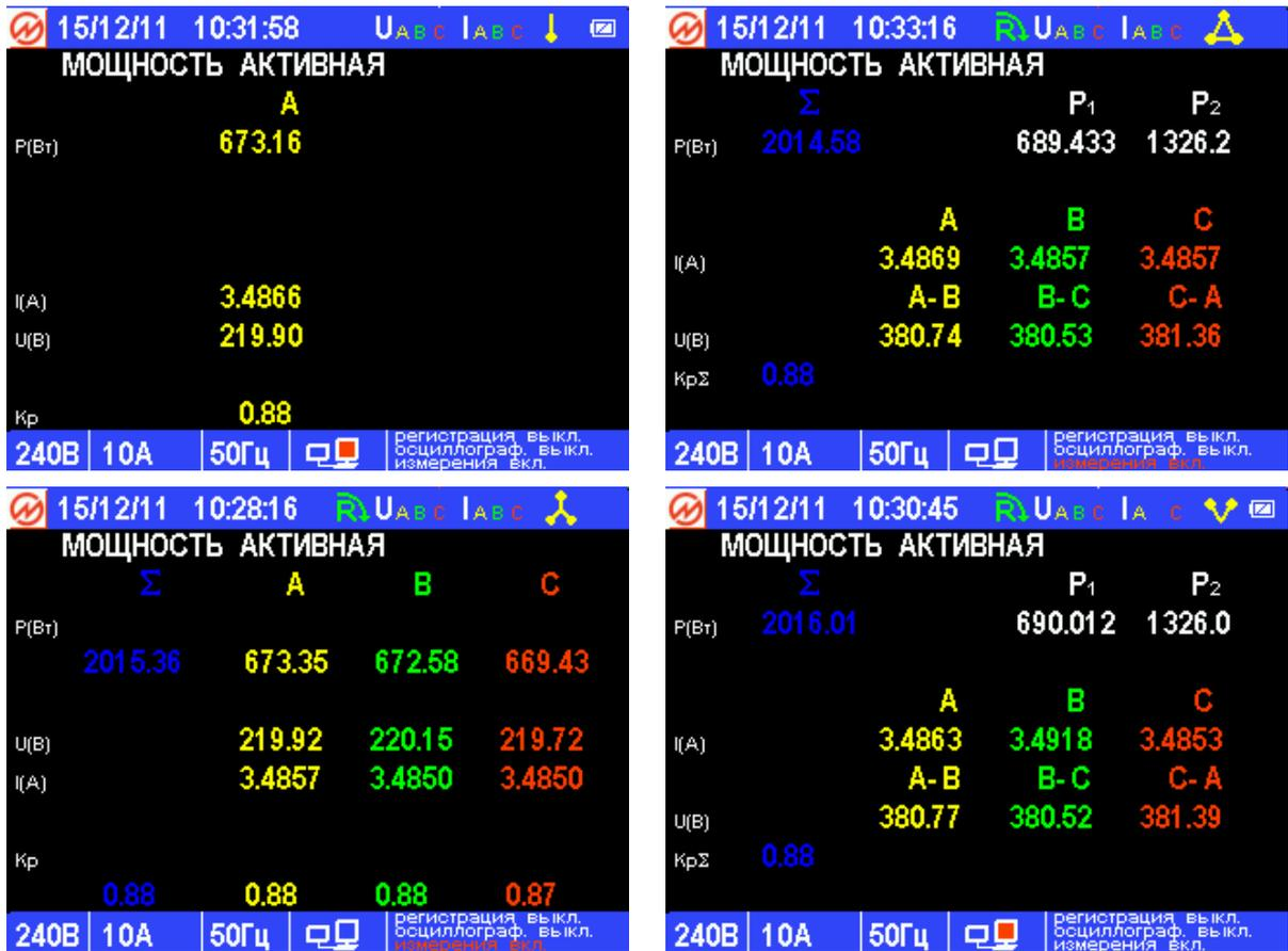
Рис. 4.7. Экраны режима отображения активной мощности для различных схем подключения
