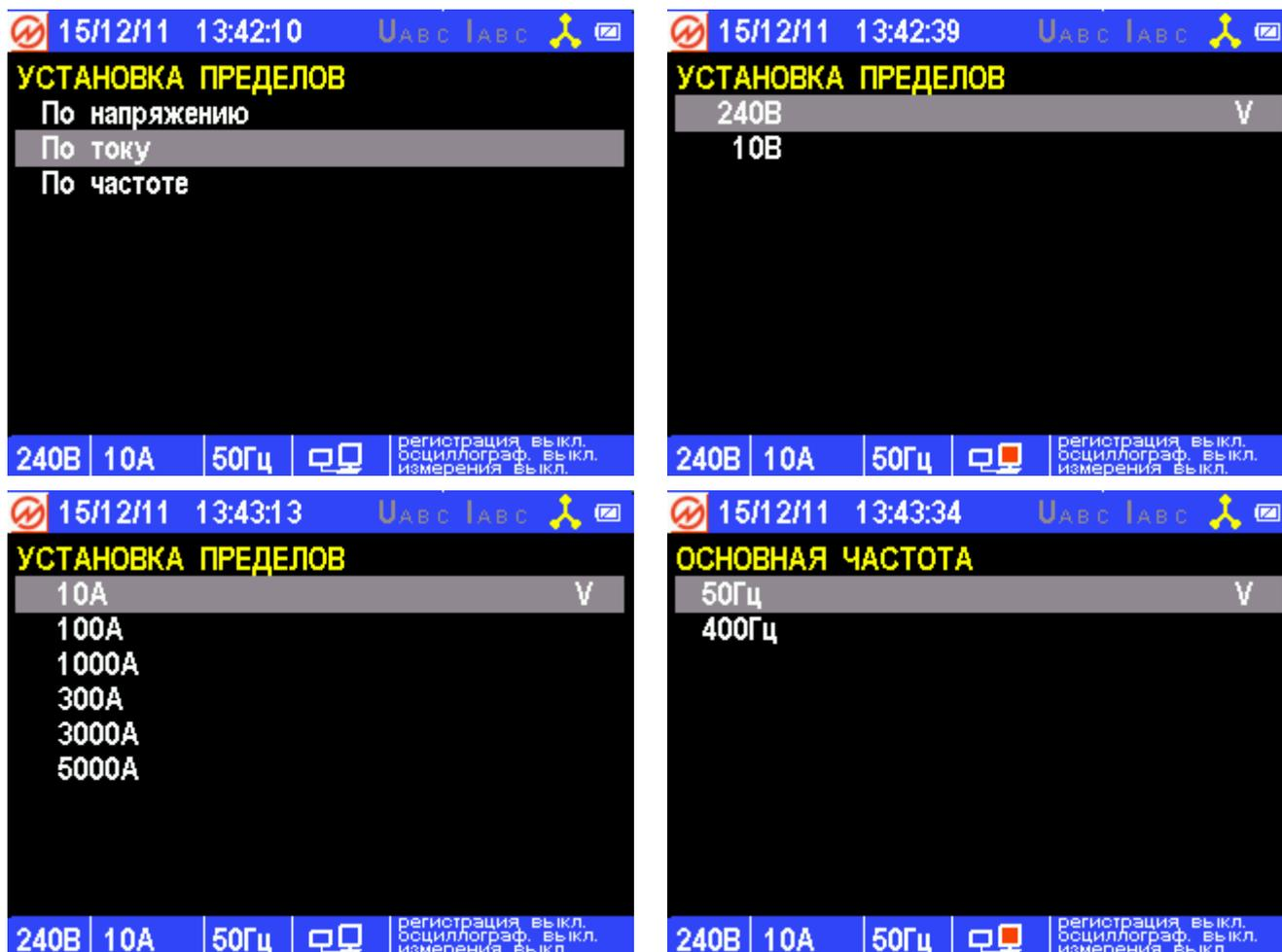
Рис. 4.42. Меню выбора пределов измерения Энерготестера ПКЭ
