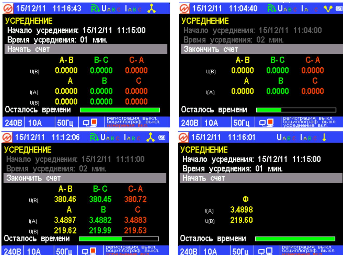
Рис. 4.13. Экраны режима отображения усредненных значений напряжений и токов
