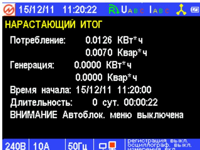
Рис. 4.15. Экран режима измерения энергии нарастающим итогом
