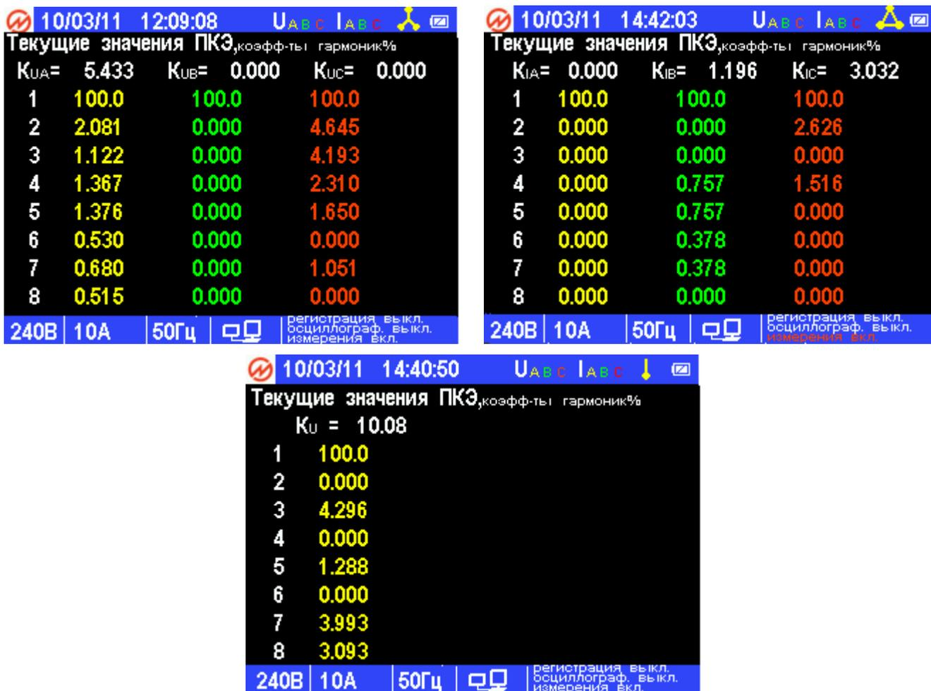
Рис. 4.30. Окна отображения текущих значений коэффициентов искажения синусоидальности и гармонических составляющих напряжений и токов для различных схем подключения
