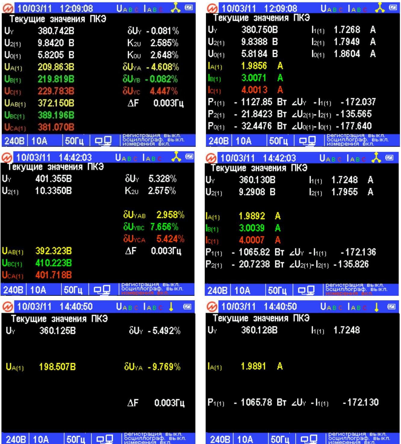
Рис. 4.29. Окна отображения текущих значений основных ПКЭ для различных схем подключения
