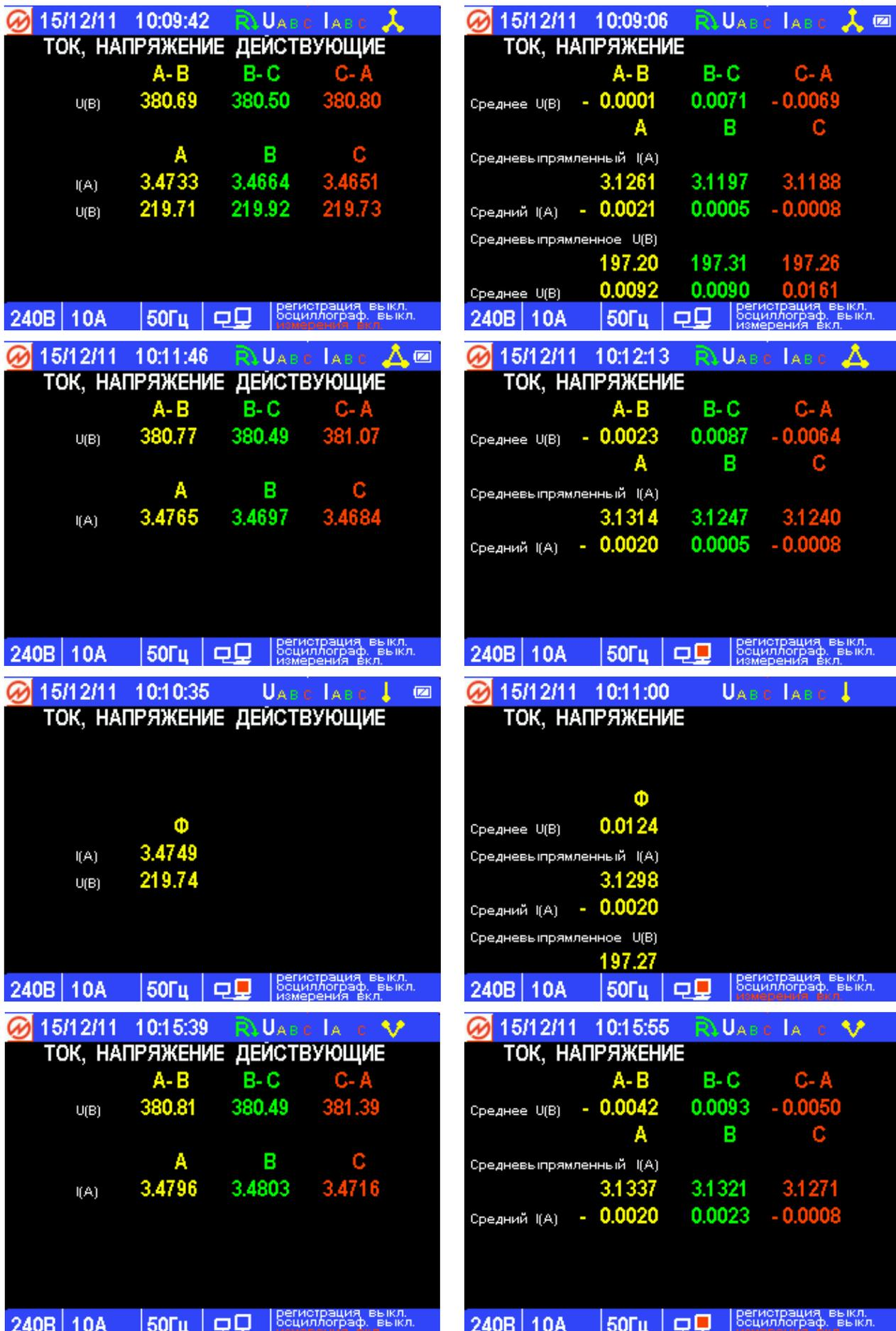
Рис. 4.6. Экраны режима «Ток, напряжение» для различных схем подключения
