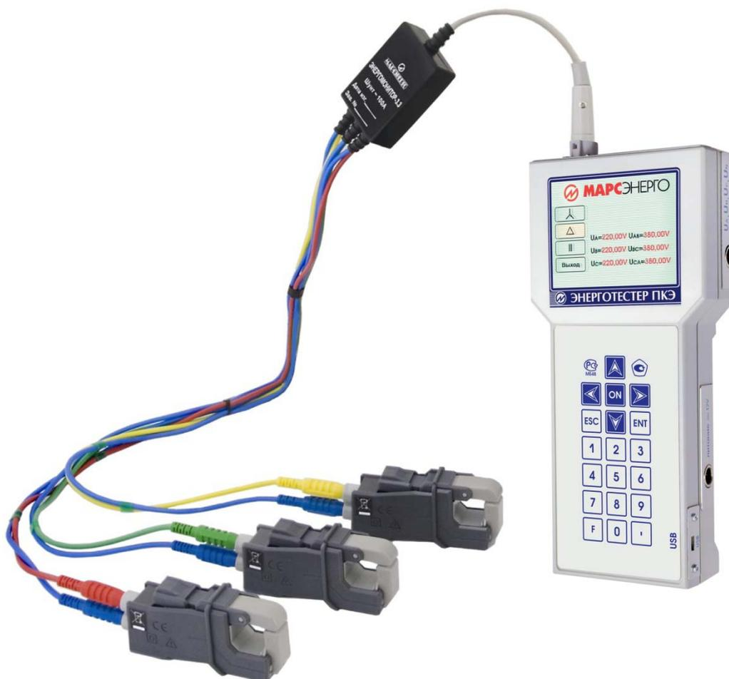
**Рис. А.4.** Схемы подключения токоизмерительных клещей 100 А к Энерготестеру через Шунт 100 А
