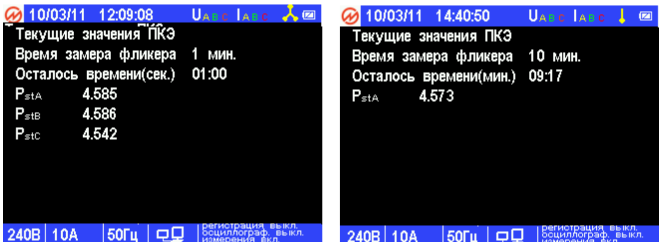
Рисунок 4.31. Окно отображения кратковременной дозы фликера для трехфазной четырехпроводной и однофазной двухпроводной схеме подключения
