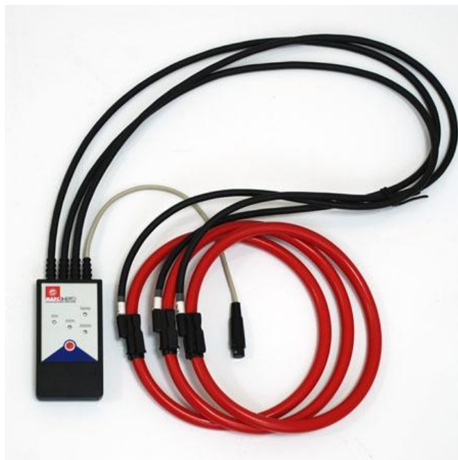
Рис. А.6. Комплект гибких токоизмерительных клещей на 30 / 300 / 3000 А
