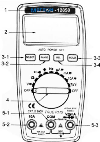
1. Обозначение модели прибора;
