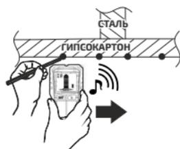
**ПРИМЕЧАНИЕ:** Повышение уровня индикации показывает наличие металла. Небольшие металлические элементы или элементы, находящиеся глубоко в поверхности могут обнаружиться, но сигнала может быть недостаточно для их точного определения и активации звуковой сигнализации. В этом случае используйте калибровку в воздухе для точного определения.
