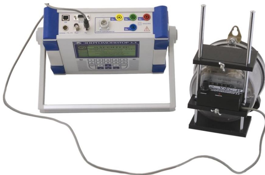
Рис. 1.1. Счетчик с УФС-И, подключенный к «ЭМ 3.3Т1»
