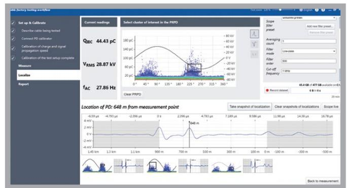
Рабочий процесс заводского испытания кабеля представляет собой отдельный пользовательский интерфейс, встроенный в программное обеспечение MPD Suite для заводских испытаний, таких как FAT. Это чрезвычайно полезный инструмент для производителей кабелей высокого и среднего напряжения.
