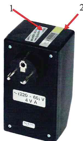
1 – Место для пломбирования и 2 – место нанесения знака поверки в виде наклейки
