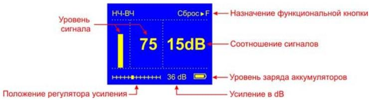
Обнулите показания кнопкой **F**. При движении вдоль трассы могут «набегать» отрицательные показания. Их следует обнулять.
