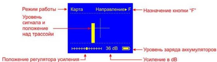
Выберите направление движения от генератора к дальнему концу кабеля. Нажав кнопку **F**, зафиксируйте направление.
