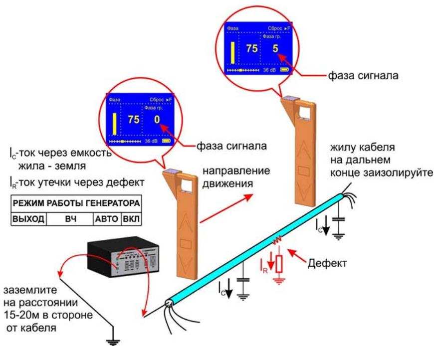
Режим «Фаза» использует двухчастотный фазовый метод. Генератор в режиме «ВЧ» посылает в линию сигнал сразу на двух частотах. После прохождения повреждения фаза сигнала изменяется.
