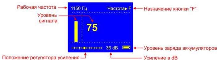
Для изменения частоты работы приемника, нажмите **F**. Кнопкой **▲** или **▼** выберете изменяемую цифру, измените значение, нажав **F**. Для возврата нажмите **OK**. Установленная частота сохраняется в энергонезависимой памяти.
