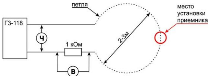
Установите приемник вертикально непосредственно на провод петли, в точку указанную на рисунке.
