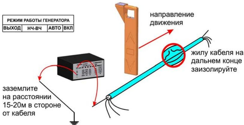
Подключите генератор к поврежденной паре. При этом рекомендуется работать на максимально коротком участке кабеля, чтобы уменьшить паразитный сигнал через емкость кабеля. Желательно, чтобы дефект был ближе к дальнему от генератора концу кабеля.
