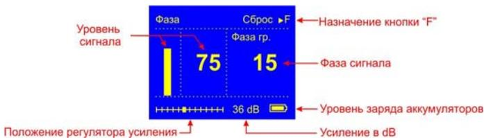
По максимальному уровню сигнала найдите точное положение кабеля. Обнулите фазу сигнала, нажав **F**. При движении вдоль трассы могут «набегать» отрицательные показания. Их следует обнулять (точно над кабелем).
