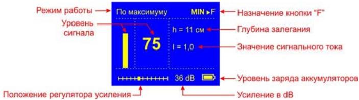
Приемник в режиме работы «по максимуму»: положение кабеля определяется по максимальному уровню сигнала. Измерения сопровождаются непрерывным контролем глубины и силы тока. По величине тока можно отличить свой кабель от чужого: в соседних коммуникациях величина тока меньше, чем в кабеле, подключенном к генератору.
