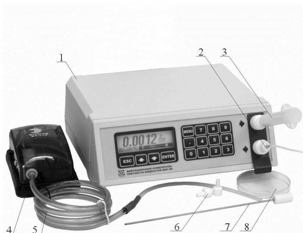
Рисунок 1 — Плотномер ВИП-2МР с принадлежностями
