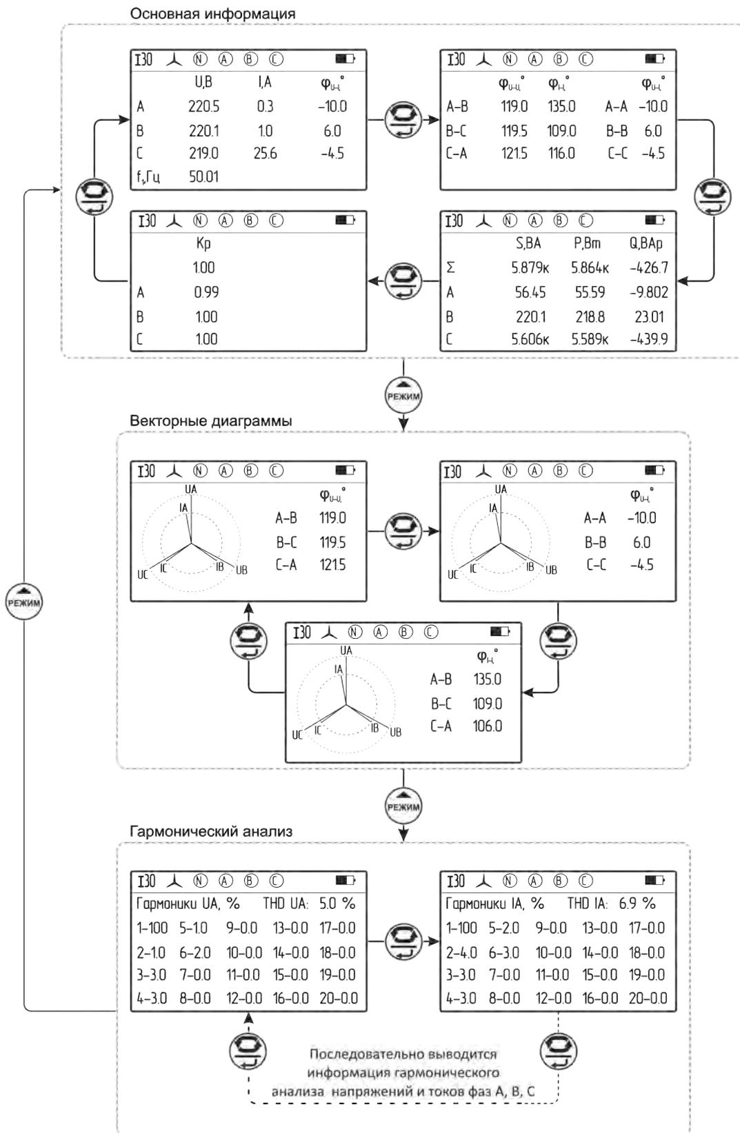
Рисунок 2.9 – Результаты измерений (3-фазная 4-проводная схема)
