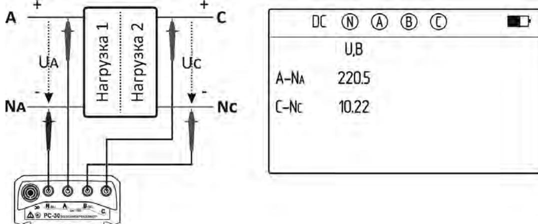
Рисунок 2.15 - Схема подключения и вид индикатора при измерении постоянных напряжений
