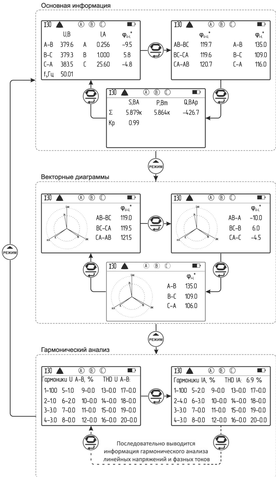
Рисунок 2.11 – Результаты измерений (3-фазная 3-проводная схема)
