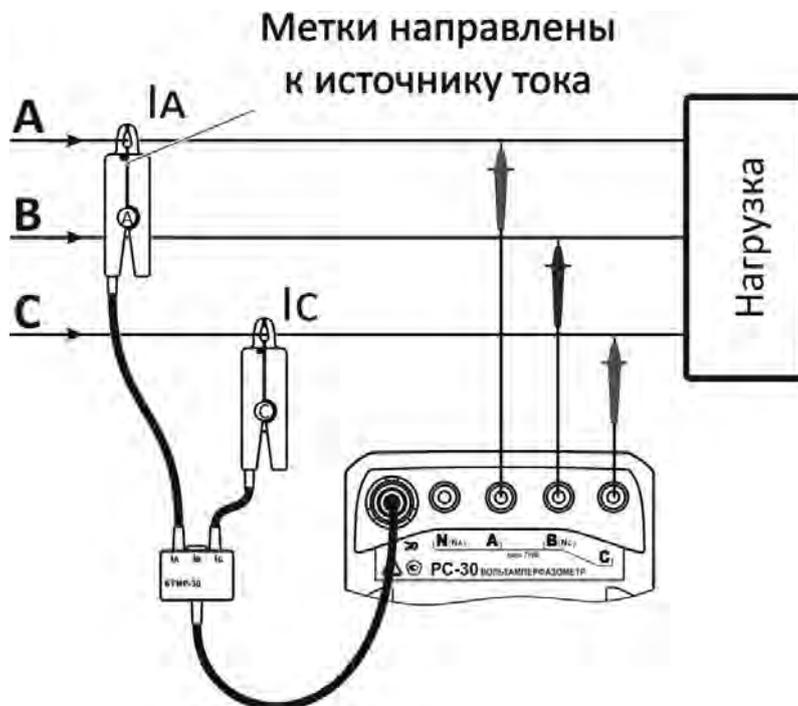
Рисунок 2.10 - 3-фазная 3-проводная схема измерения
