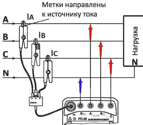
Рисунок 2.8 - 3-фазная 4-проводная схема измерения
