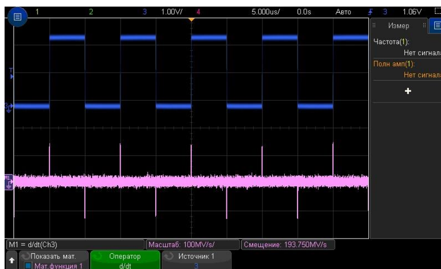
Рис. 8 Пример функции дифференцирования
