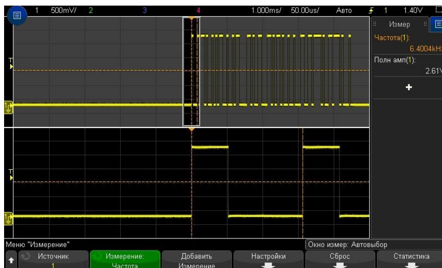
Рис. 49 Выделение события с целью измерения частоты
