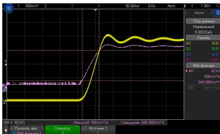
Рис. 11 Пример использования математической функции \sqrt{\quad} (квадратный корень)
