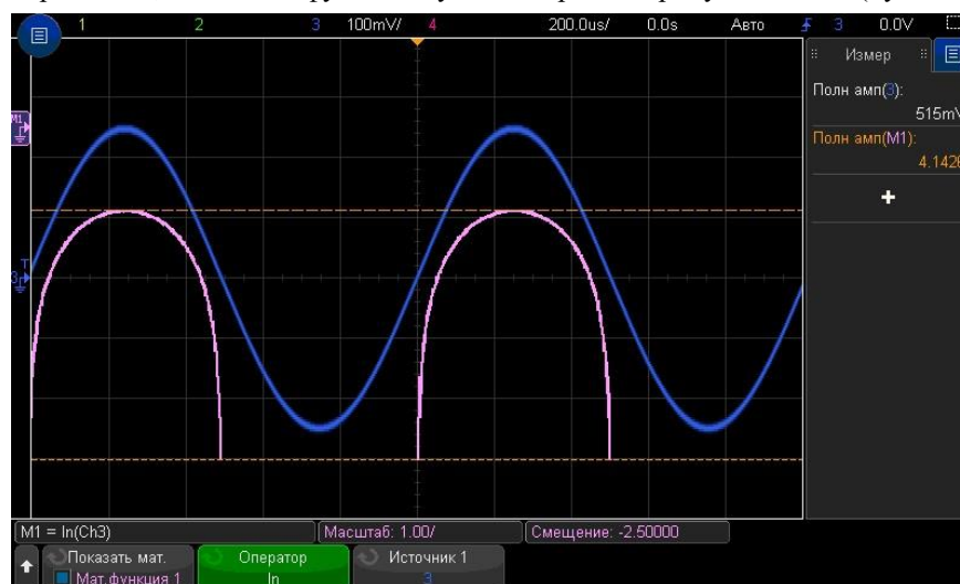
Рис. 14 Пример использования математической функции натуральный логарифм
