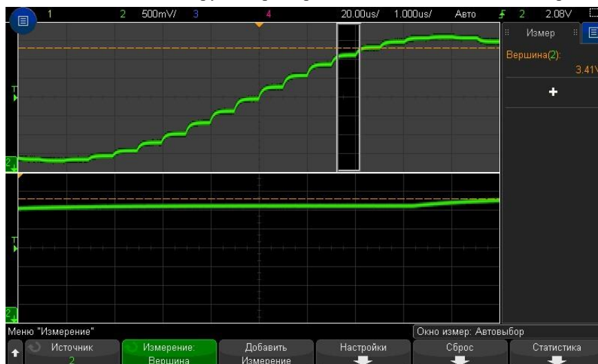
Рис. 47 Выделение области для измерения вершины
