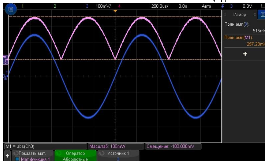
Рис. 13 Пример использования математической функции абсолютного значения
