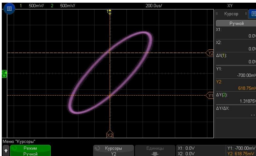
Рис. 4 Измерение угла сдвига фаз (автоматическое и с помощью курсоров)
