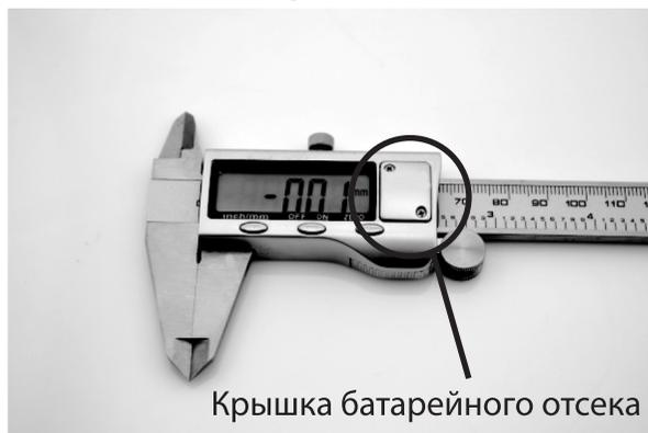
Отключите прибор, снимите крышку батарейного отсека. Установите новую батарею, соблюдая полярность. Закройте крышку.
