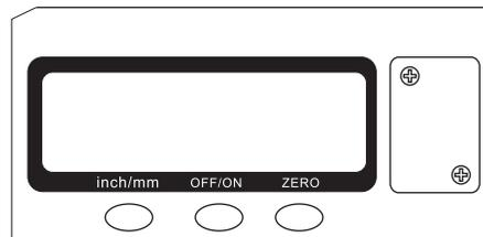
ON/OFF – включает и выключает прибор. Прибор отключится автоматически через 5 мин простоя.
