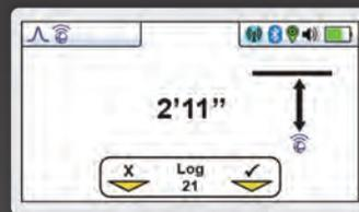
Измерение глубины маркеров и сохранение данных с GPS
