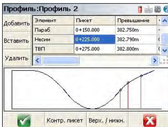
На показанном примере вертикальный профиль начинается точкой ТВП Параб. После этого была задана точка ТВП Несим для асимметричной вертикальной кривой, а также другой элемент ТВП. Обратите внимание, что выделенный элемент Несим (асимметричная парабола) отображается в области просмотра.
