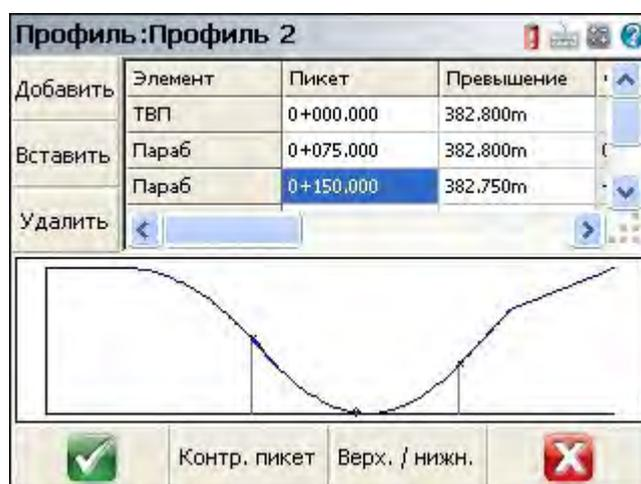
На показанном примере вертикальный профиль начинается точкой ТВП. Затем была определена точка ТВП для вертикальной кривой, а также другая параболическая кривая. Обратите внимание, что выделенный элемент Параб (парабола) отображается в области просмотра.
