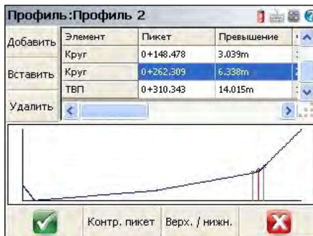
На показанном примере вертикальный профиль начинается точкой ТВП. Далее была определена первая вертикальная круговая кривая, затем еще два элемента круговой кривой, а чтобы завершить их, необходим окончательный ТВП. Обратите внимание, что выделенный элемент круговая кривая (circular curve) отображается в области просмотра.
