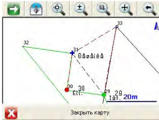
FieldGenius рассчитывает новую границу таким образом, чтобы она пересекала сегменты границы, соединенные с заданными начальной и конечной точками.
