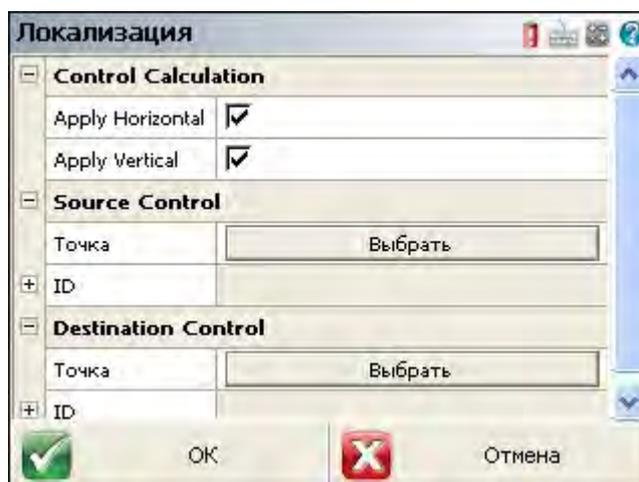
Подтвердите тип контрольной пары (2D или 3D или без типа), установив флажки Apply Horizontal (применить по горизонтали) и Apply Vertical (применить по вертикали). Нажмите Выбрать для выбора контрольной точки источника и контрольной точки назначения. Откроется стандартный инструмент выбора точки для ввода или выбора точки.
