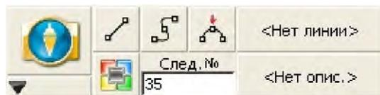
Панель инструментов топографии используется для автоматизации графических построений, а также для отображения описания и номера следующей точки съемки. Как и в предыдущих версиях FieldGenius, вы можете управлять созданием чертежа, настраивая переключатели линий, дуг и кривых. Имеется также программируемая пользователем кнопка, позволяющая запускать любую команду.
