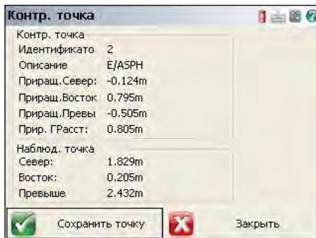
Показанные на нем ошибки получены путем вычитания координат съемки из известных координат. Другими словами, если сложить значения ошибок с координатами точки съемки, то получатся координаты известной точки.
