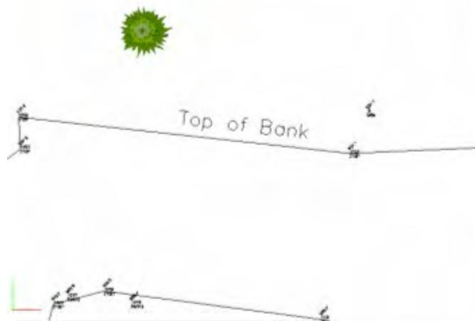
Эта линия соответствует положению на местности, где уклон изменяется при переходе от крутого холма к относительно плоской поверхности.
