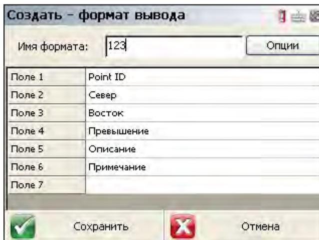
В FieldGenius можно создать пользовательский файл в формате ASCII для экспорта. Эта опция позволяет добавлять дополнительную информацию к стандартному формату файла ASCII. Просто нажмите на серую область, чтобы добавить дополнительную информационную строку, и выберите из раскрывающегося меню элемент, который хотите добавить.
