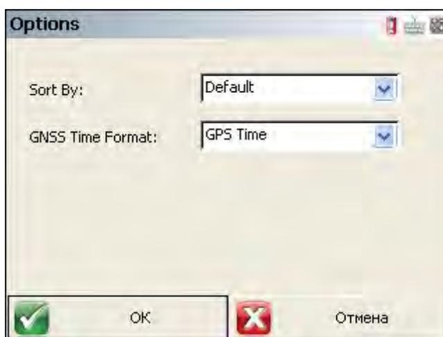
Также в правом верхнем углу имеется кнопка опций, где вы можете запросить конкретный файл ASCII, выполнить сортировку по идентификатору точки или типу измерения, а также задать формат времени для GNSS.
