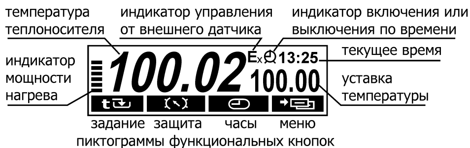
Рисунок 3 — Дисплей в режиме регулирования по уставке
