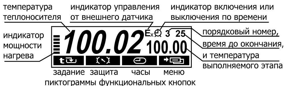
Рисунок 4 — Дисплей в режиме регулирования по программе
