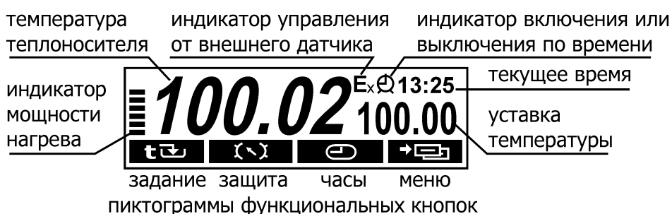
Рисунок 3 — Дисплей в режиме регулирования по уставке
