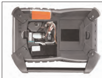
Удобный сервисный отсек обеспечивает быстрый доступ к подверженным износу компонентам
