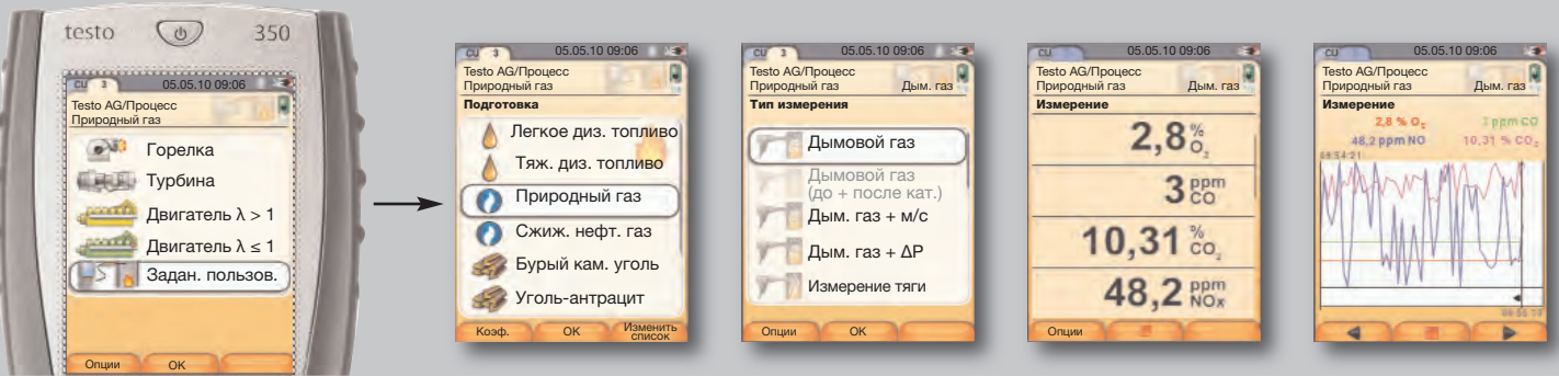
1. Выбор области применения → 2. Выбор топлива → 3. Выбор типа измерения → 4. Измерение → 5. Документирование
