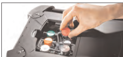
«Подключи и работай»: чрезвычайно простая технология замены сенсоров газа
