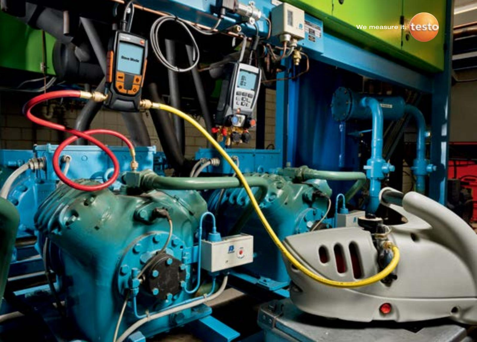
Для того, чтобы сохранить, распечатать или задокументировать результаты измерений в электронном виде, Вы можете подключить вакуумметр testo 552 к цифровому манометрической коллектору testo 570 с помощью кабеля. При проведении долгосрочных измерений данные могут регистрироваться и сохраняться в течение нескольких дней.
