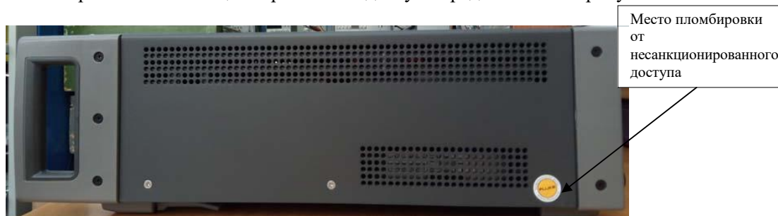
Рисунок 2 - Схема пломбировки от несанкционированного доступа
