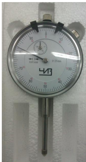
Рисунок 2 – Индикатор часового типа ИЧ 25
