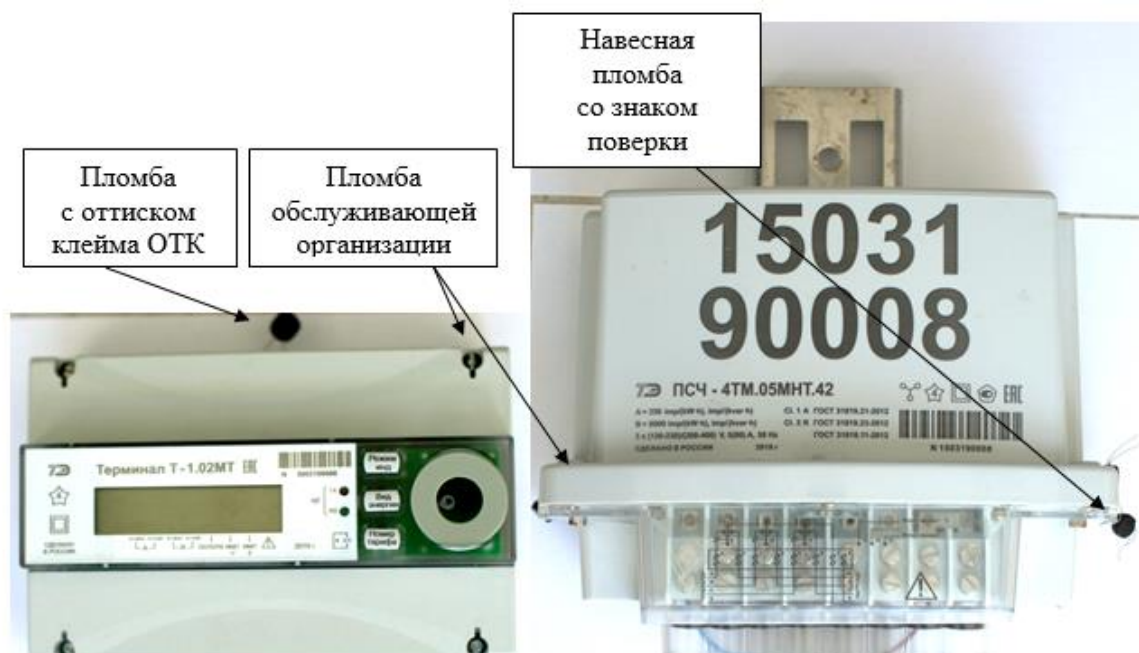
Рисунок 1 – Общий вид счётчика наружной установки и терминала Т-1.02МТ, схема пломбировки и обозначение места нанесения знака поверки
