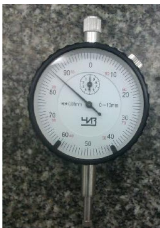
Рисунок 1 – Индикатор часового типа ИЧ 10
