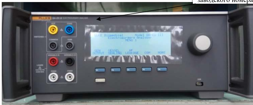
Рисунок 1 - Общий вид анализатора электрохирургических устройств QA-ES III
