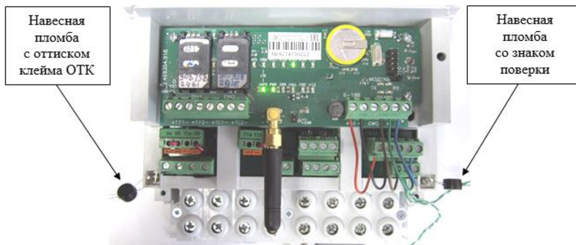
Рисунок 3 - Вид счетчика внутренней установки со снятой крышкой зажимов
